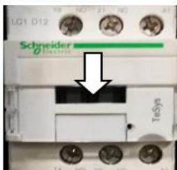
L'activation du contacteur est trop longue. Normalement, le contacteur et la pompe devraient s'activer immédiatement après l'activation de la sortie Q0.
