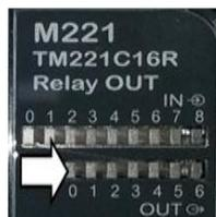
Vérifier si le signal de sortie Q0 est stable.
