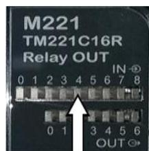
Si la lumière de l'entrée I4 n'est pas stable, il est possible qu'une vis soit probablement mal serrée et le fils qu'elle retient est lâche, ce qui provoque des coupures de signal aléatoire.
