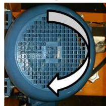
Vérifier le sens de rotation du moteur électrique.
