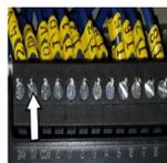
Activer le bouton action et vérifier si le 24Vdc se rend jusqu'à l'entrée I3. Avec un voltmètre en mode DC, connecter la sonde noire sur la vis 0V DC OUT dans le haut de l'automate programmable.
