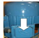
connexion T1, T2 et T3 dans la boîte de jonction sur le moteur
