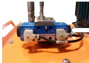
Activer la pompe hydraulique et à l'aide de la pointe d'un tournevis, appuyer sur le bouton d'activation manuel de la valve pour vérifier si la mécanique de la valve fonctionne bien.
