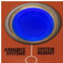
S'assurer que toutes les portes de sécurité sont bien fermées et appuyer sur le bouton d'amorçage du système pour réarmement le relais de sécurité. (optionnel)
