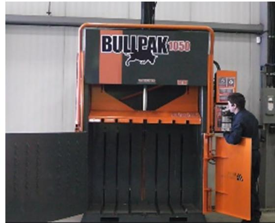
Étape 5 - Retirer le pont filaire (étape 2) et remettre le contact d'éjection (étape 2), puis fermer les portes de la presse. Elle effectuera un cycle d'étalonnage, puis la porte de chargement s'ouvrira.
